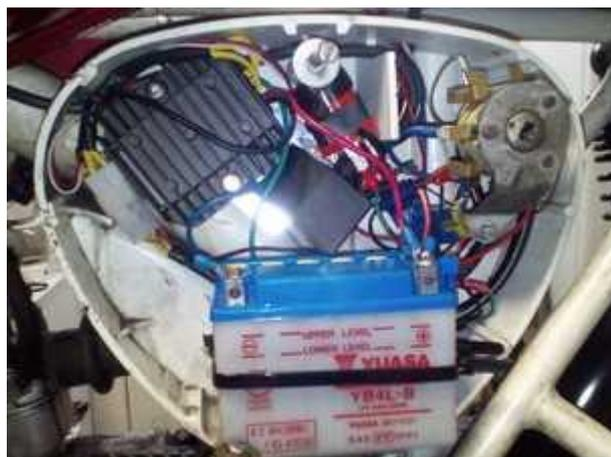
Diese bleibt genau so verdrahtet wie das laut VAPE Plan vorgesehen ist. Das rote Ding über der Zündspule ist der Blinkgeber. Hinter der Batterie, also nicht im Bild, gibt es noch einen zentralen Massesternpunkt in Form einer M6 Schraube mit Mutter wo ein halbes Kilo Ringösen mit den diversen Massen zusammenlaufen. Batterie, Motormasse, Lampen vom oberen Rahmenpunkt, Beleuchtung hinten, USB-Lader ect. pp..
