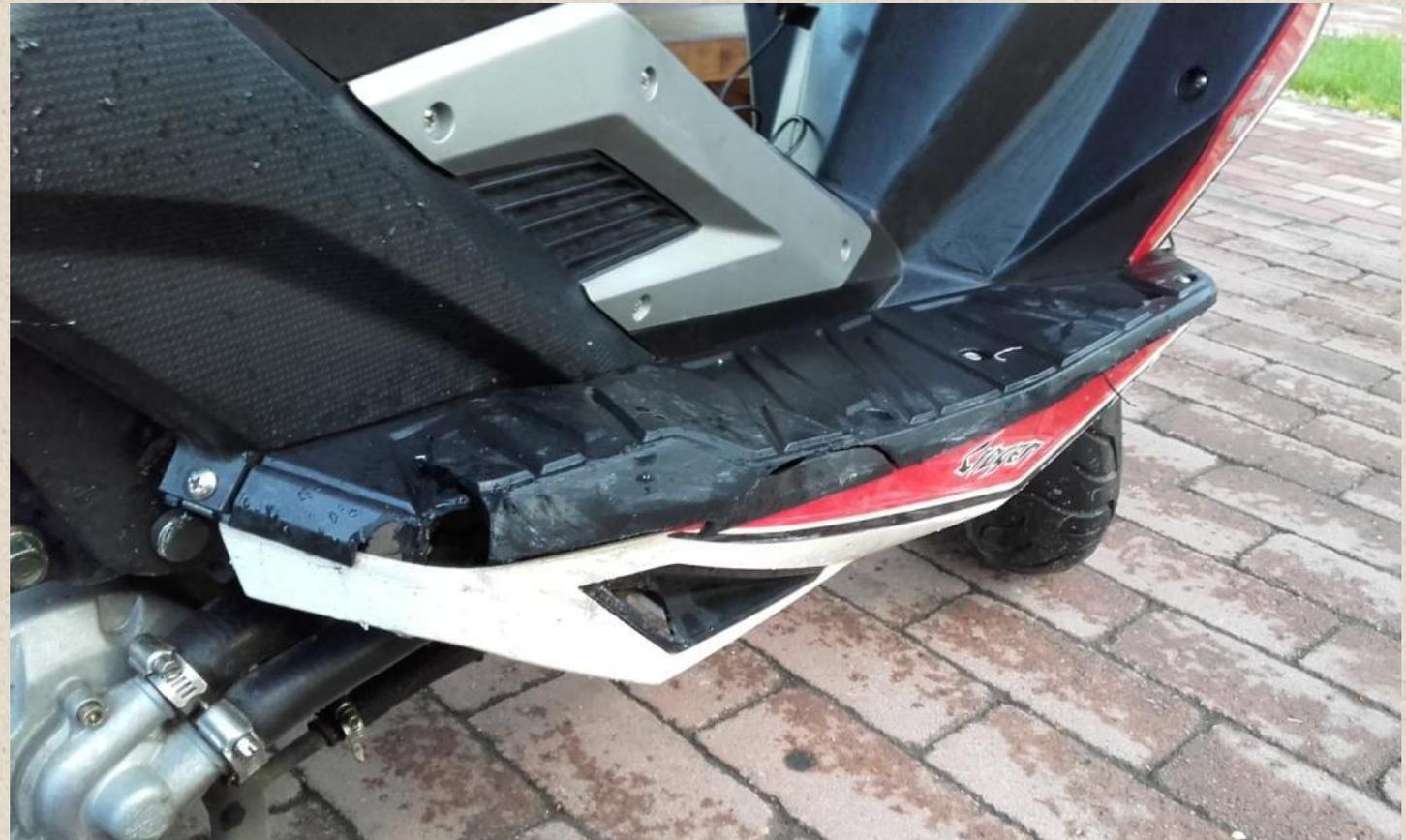
Verkleidung rechts muss ersetzt werden sonst alles intakt
