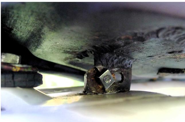
Sitzhalterungsreparatur mit Batteriepolverschraube aus der alten Batterie.
